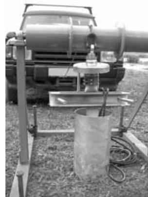
7) Avec le tuyau complètement tendu et le câble déjà attaché (en laissant du jeu pour que le tuyau s'étire), procédez à la fixation de la partie supérieure du tuyau Rylbrun (le couvercle) à l'avant du véhicule.
