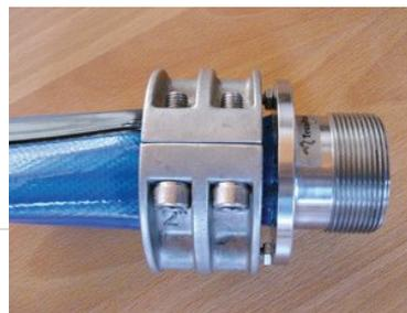
24) Placez la pince et serrez les 4 vis Allen jusqu'à ce que les deux pinces s'assemblent complètement et que les vis soient bien serrées.
