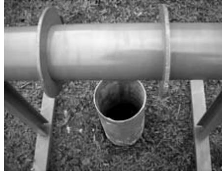
Le rouleau peut être acheté chez Hidric ou vous pouvez le fabriquer vous-même. Il est placé juste au dessus de l'ouverture du puits
